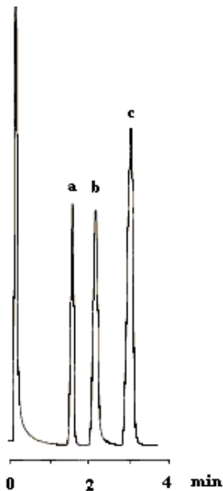
Figura 33. Cromatograma de metadona y metabolitos (EMDP Y EDDP). Condiciones experimentales: Columna: Heliflex® AT-Drug 2, 10 m x 0,53 mm x 1,20 µm; Condiciones isotérmicas: 200 °C; Carrier: Helio a 20 mL/min; Detector: FID a 300 °C. Identificación de los picos: a. EMDP, b. EDDP, c. Metadona (25).
