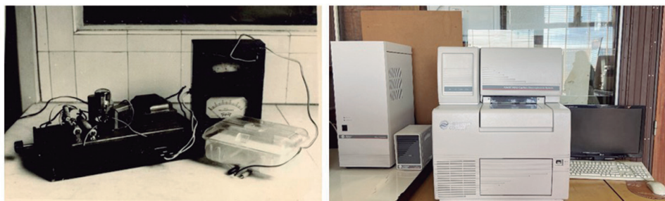
Figura 1. Equipo construido por el Dr. Castagnino para realizar las experiencias correspondientes a su Tesis de Doctorado (izquierda). Equipo de Electroforesis Capilar del STA-IQUIBICEN – CONICET (derecha).
