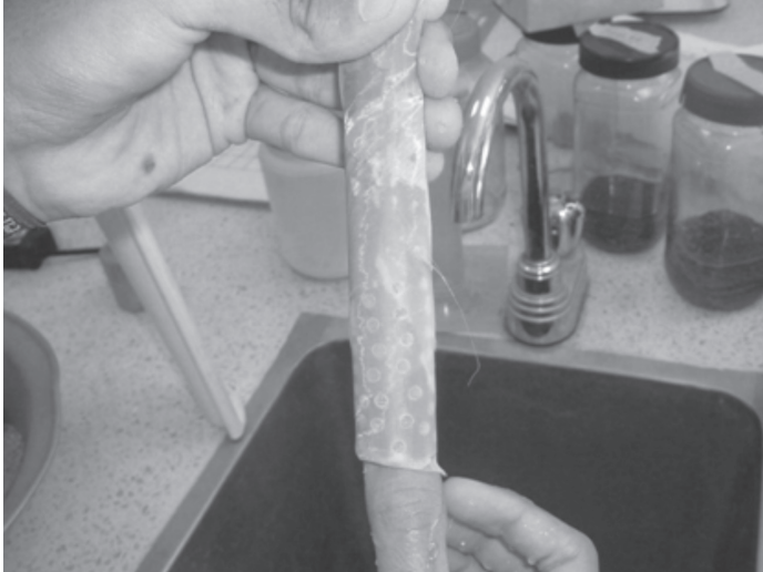
FIGURA 2. Instalación de malla (organza)
