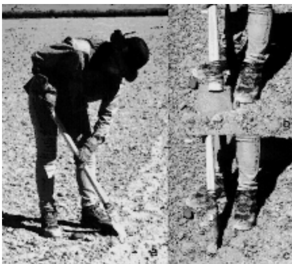
Figura 4. Modo de acción puntear. Forma de utilización: (a) penetración del instrumento en el suelo; (b) detalle visto de frente; (c) rotación de 90° del instrumento en el sedimento.
