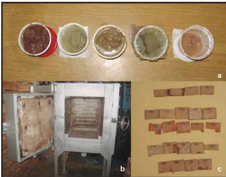
Figura 6. Procedimiento experimental. a. Hidratación de arcillas. b. Horno eléctrico. c. Briquetas experimentales.
