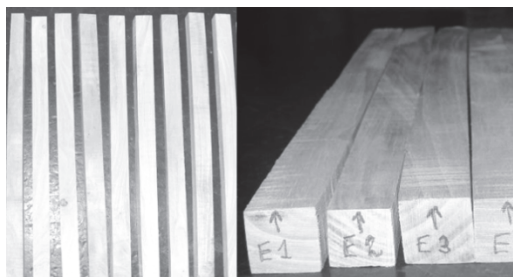
Figura 3. Fotografía de las probetas para los ensayos de flexión estática. Se obtuvieron 4 probetas por árbol, de 20 mm x 20 mm de lado y 340 mm de largo.
