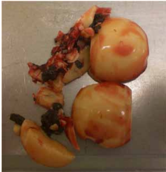
Figura 3. A. Restos de la cabeza femoral de cerámica fracturada. B. Cono Morse del tallo femoral deformado y la cabeza femoral fracturada.
