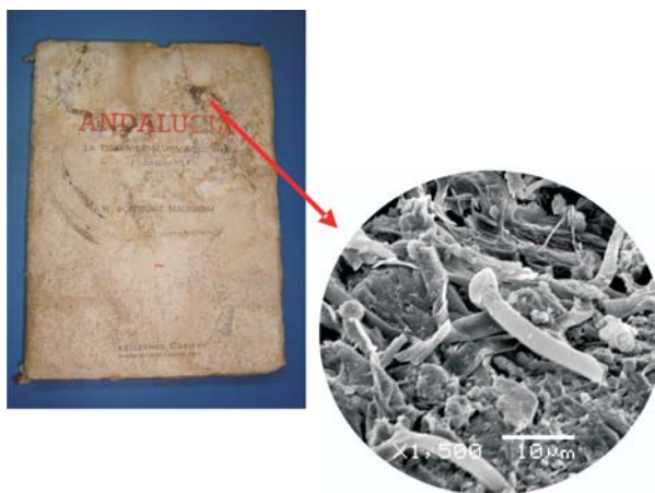
Figura 1. Libro almacenado en archivo* con signos de biodeterioro (manchas ocasionadas por crecimiento fúngico). Microfotografía de MEB (Jeol 6360LV) de la zona señalada (1500X). Se observa la colonización fúngica sobre el papel.
