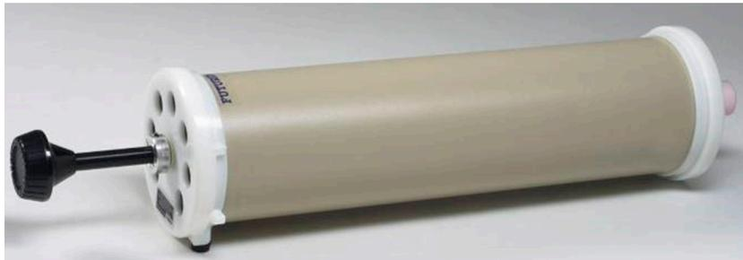
Figura 1. Jeringa de calibración de 3 litros
