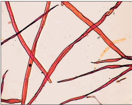
Figura N° 3: Fibras de *P. elliotii* tratadas por el método de dióxido de cloro - carbonato
