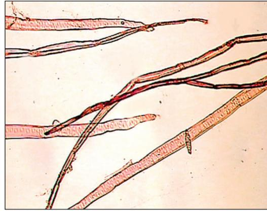
Figura N° 5: Fibras de *P. elliotii* tratadas con monoetanolamina alcalina.
