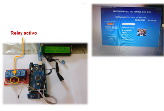
Figura 9: Demostración práctica del funcionamiento del sistema donde el código leído se encontraba en la base de datos.
