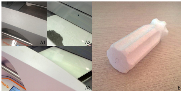
Figura 2: Preenchimento da plataforma da Z-Printer 650 com o insumo (A1 e A2); confecção do modelo (A3); peça finalizada (B)
