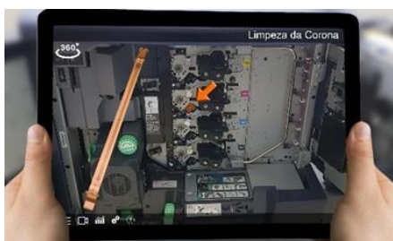
Figura 12. Limpeza da Corona com o auxílio do instrutor virtual
