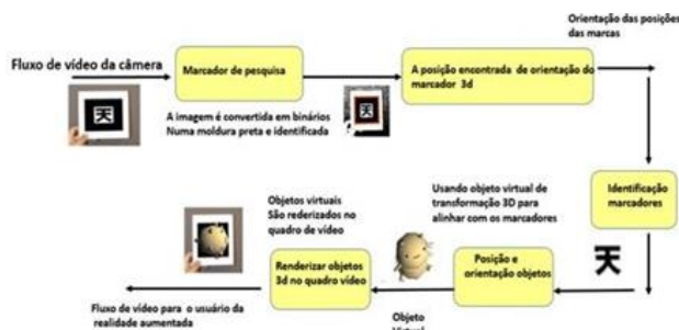
Figura 2. Esquema de funcionamento da Realidade Aumentada ART toolkit [8]
