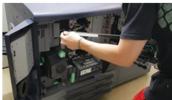
Figura 9. Limpeza da Corona
